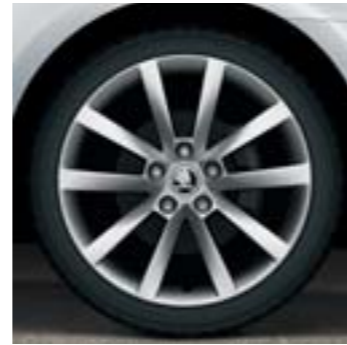
Kolo z lehké slitiny Alaris 7,5J x 18" pro pneumatiky 225/40 R18, ve stříbrné barvě (5E0 071 498D 8Z8)
